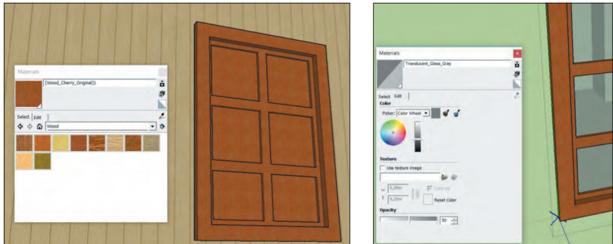
Малюнок 1.22: зліва – застосування матеріалу на цілий компонент, справа – додавання матеріалу до компонента в режимі редагування
